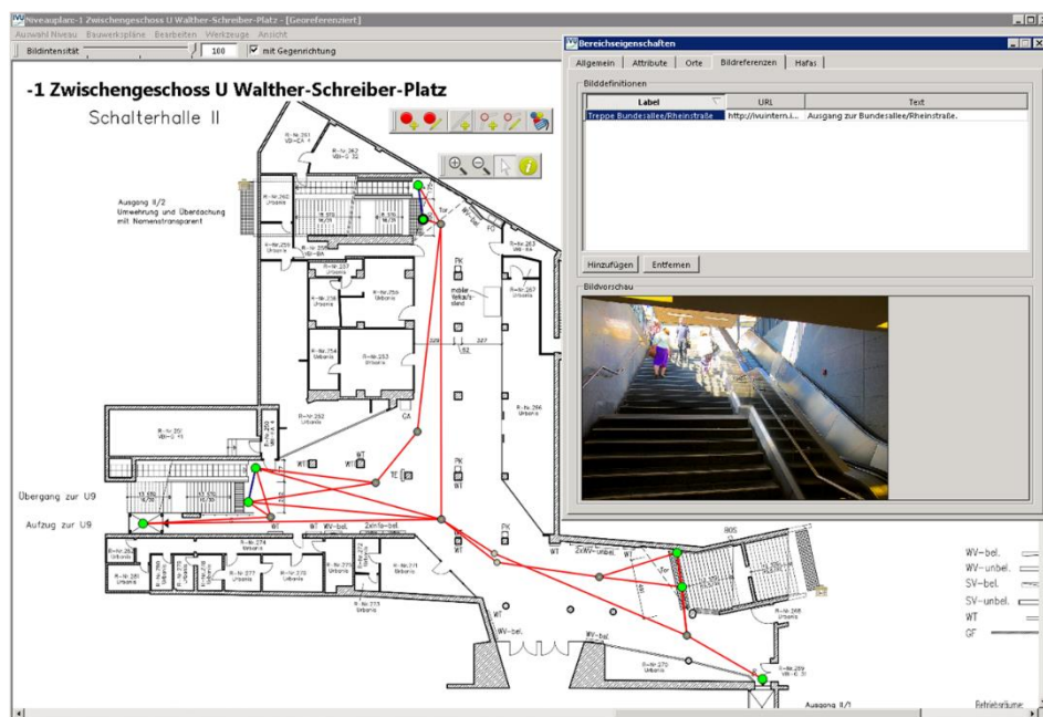
Abbildung 28: Tatsächlicher Wegeverlauf / Realgraph in einem Umsteigebauwerk inkl. eingebundenem Bild
