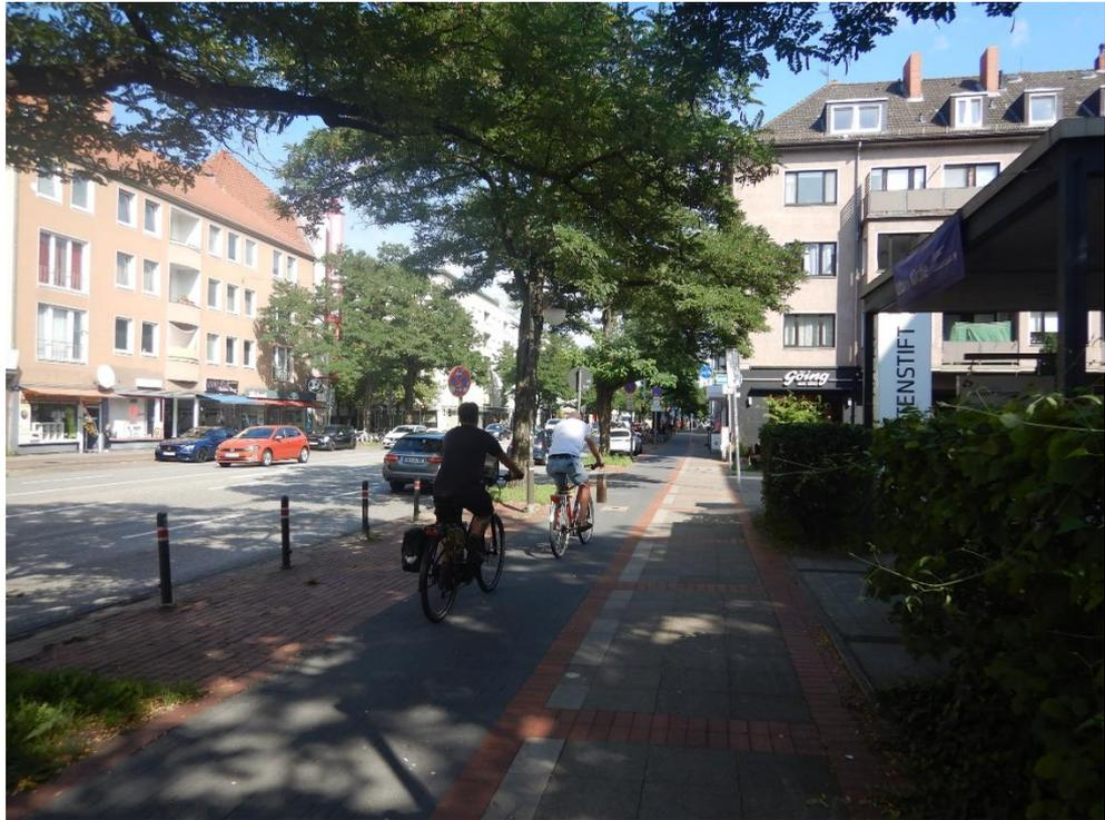
Abbildung 5 Vorgezogener Seitenraum im Sichtfeld zwischen Radweg und Fahrbahn
