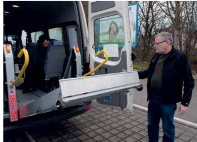
Bild 14: Bürgerbus Denkendorf mit Rollstuhllift
