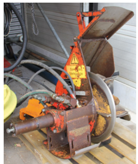
Der Einsatz von Grabenfräsen ist zu vermeiden.
